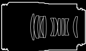
Configurazione Ottica (10 elementi / 9 gruppi)
